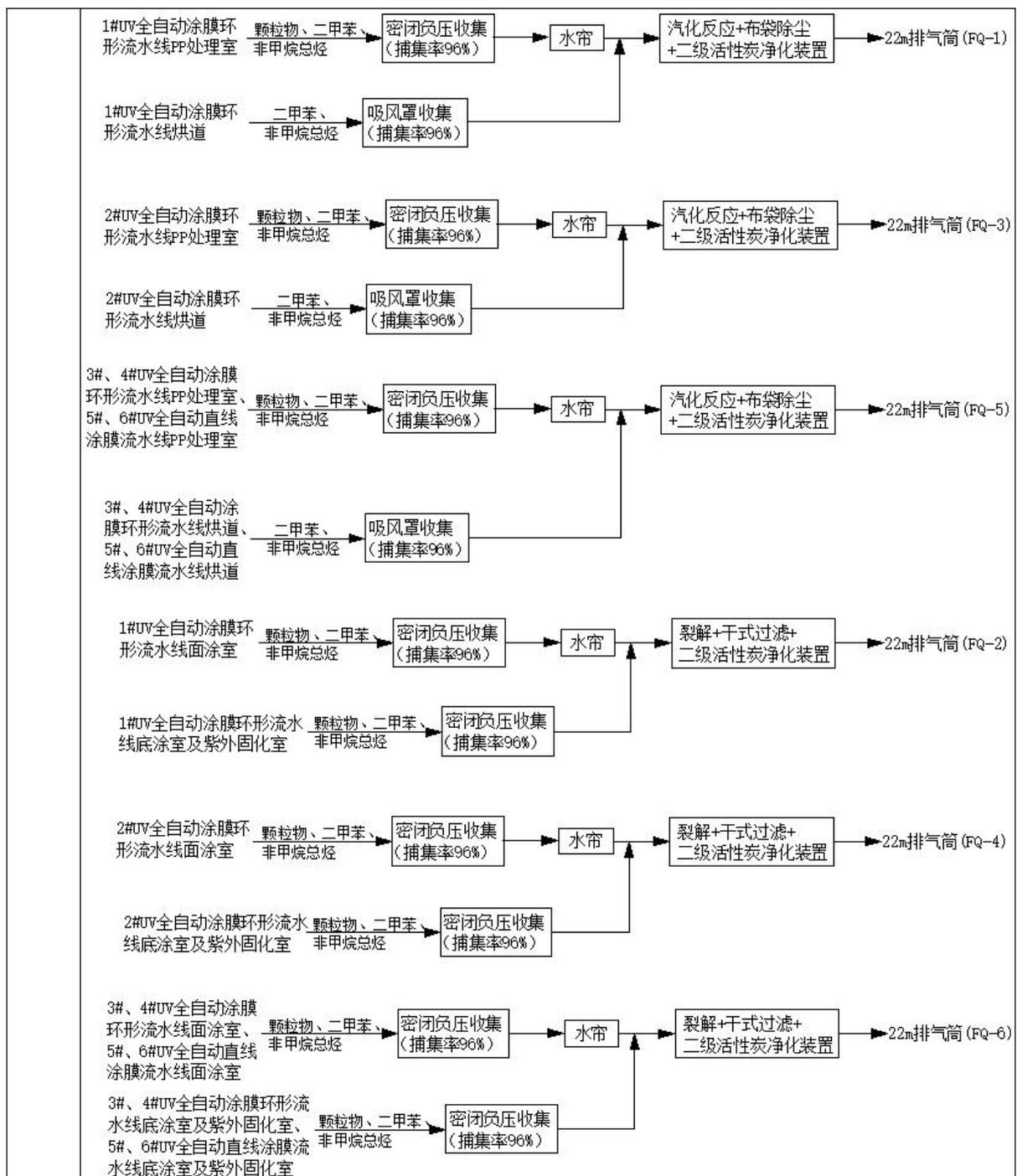
图 4-1 本项目废气收集处理示意图
